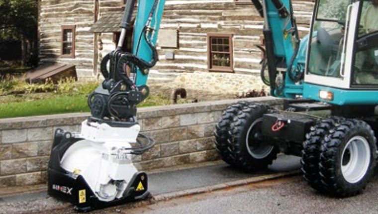
PLB 450. Abfräsen von Bordsteinen.
