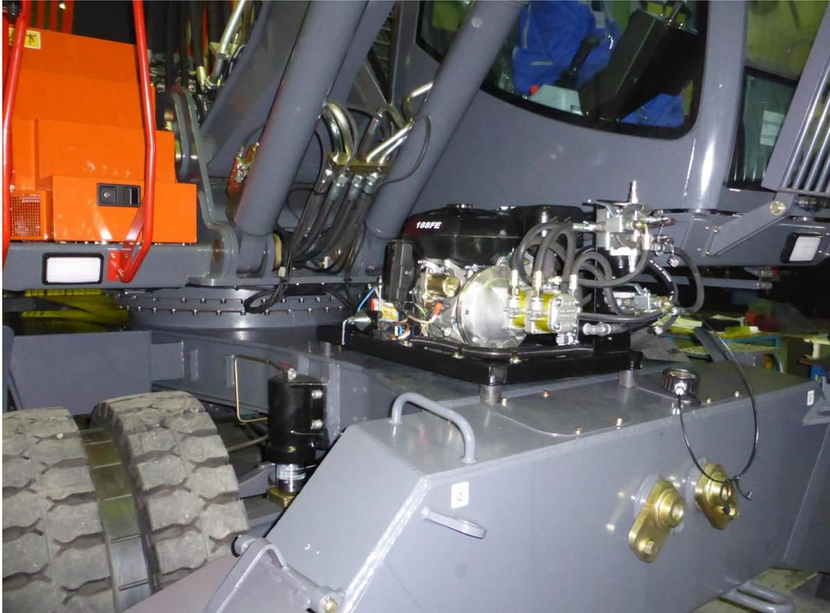
**Not-Aggregat zum Bewegen der Maschine (benzinbetrieben)
