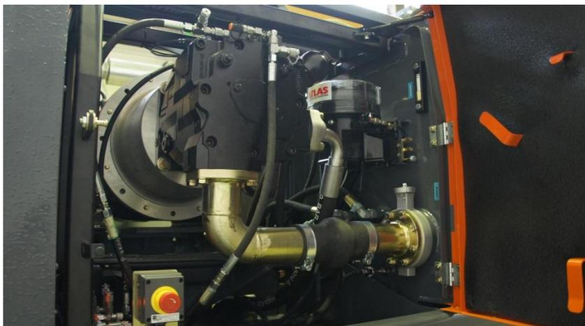
Hauptpumpe und absperrender Saugflansch
