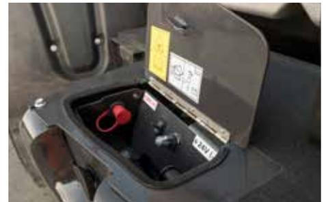
Elektrisch öffnende Motorhaube und Batterie-Hauptschalter. Anschlüsse für den Fremdstart.
